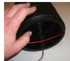
4. Oberteil aufsetzen, Fixierung und Schutzgitter anbringen und Lüftereinheit ins Fixrohr einschieben.
